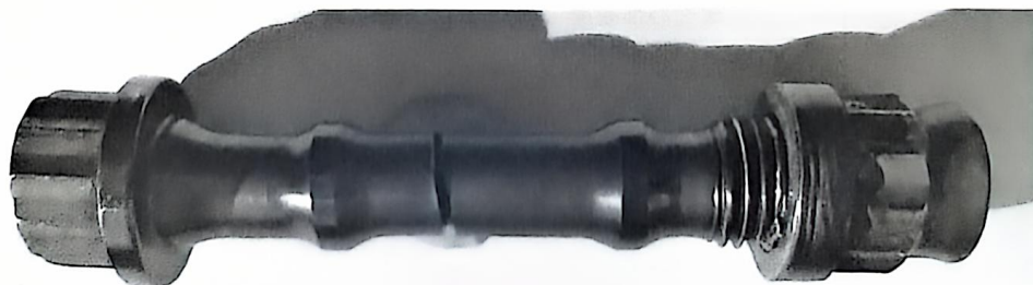
图 8-10 断裂螺栓的宏观形貌
