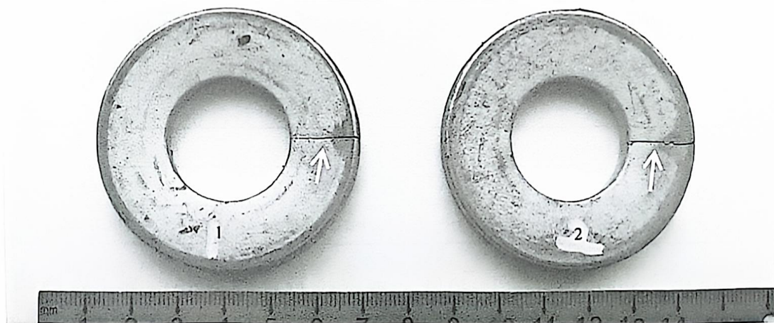
图 7-19 开裂垫圈的宏观形貌
