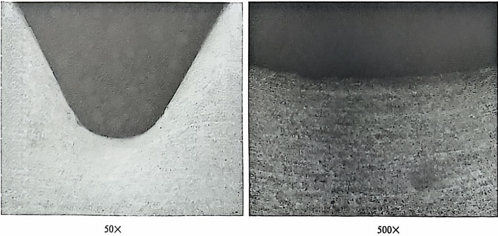
图 7-10 3#螺栓螺纹底部截面的显微组织
