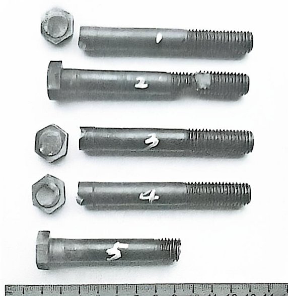
图 7-6 主轴缸盖螺栓断裂后的宏观形貌
