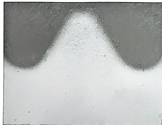
图 7-18 螺纹截面的显微组织 25×
