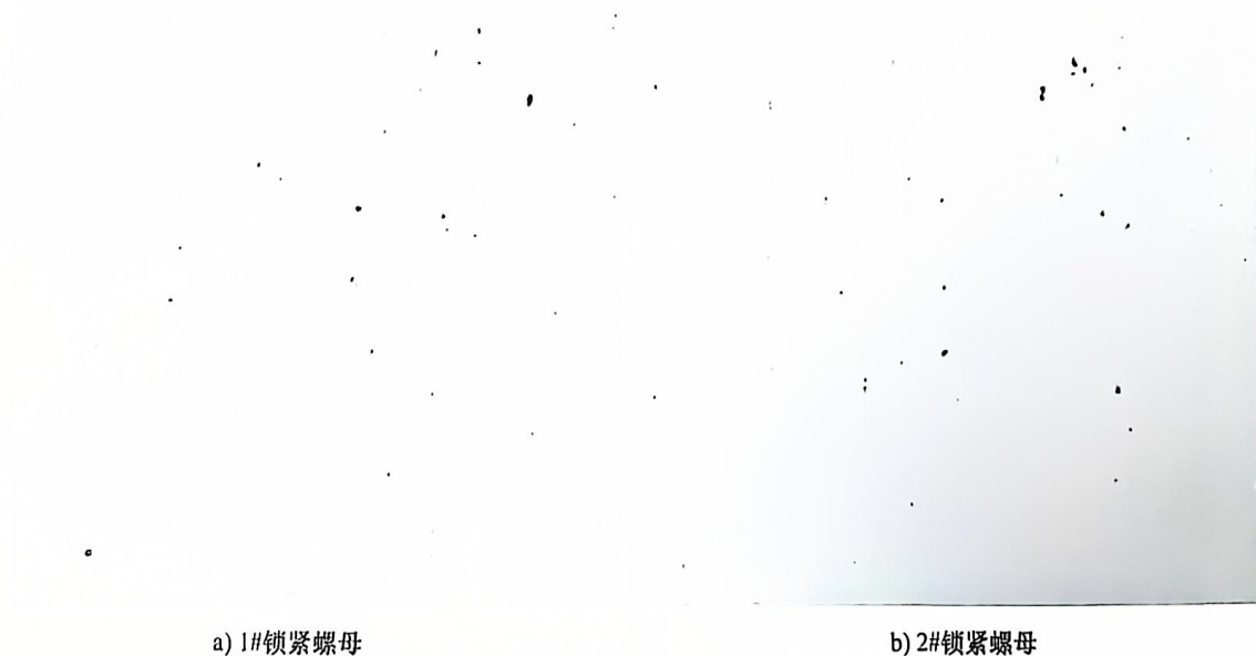
图 7-28 锁紧螺母的非金属夹杂物 100×
