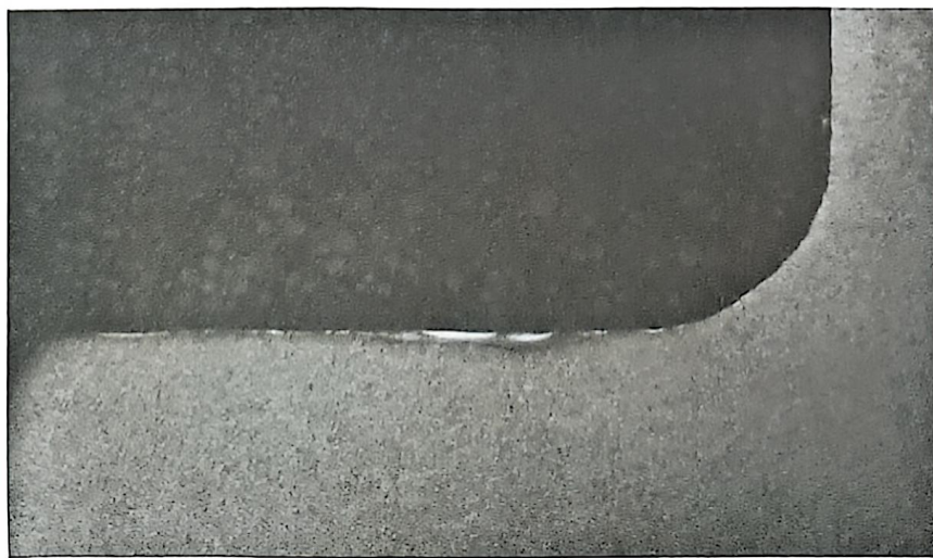
图 7-12 4#螺栓头杆过渡圆弧处的微观形貌 25×
